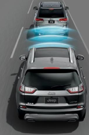
**어댑티브 크루즈 컨트롤 스톱 & 고 (ACC)** 고속도로에서 크루즈 기능을 이용해 주행시, 앞차와의 안전 거리를 걱정할 필요가 없습니다. 이 시스템은 크루징 속도를 자동으로 조절하여 사전에 설정된 앞차와의 간격을 유지하고, 운전자 조작 없이도 충돌을 피하기 위해 지프 체로키(Jeep Cherokee)를 완전히 정차시킬 수 있습니다.
