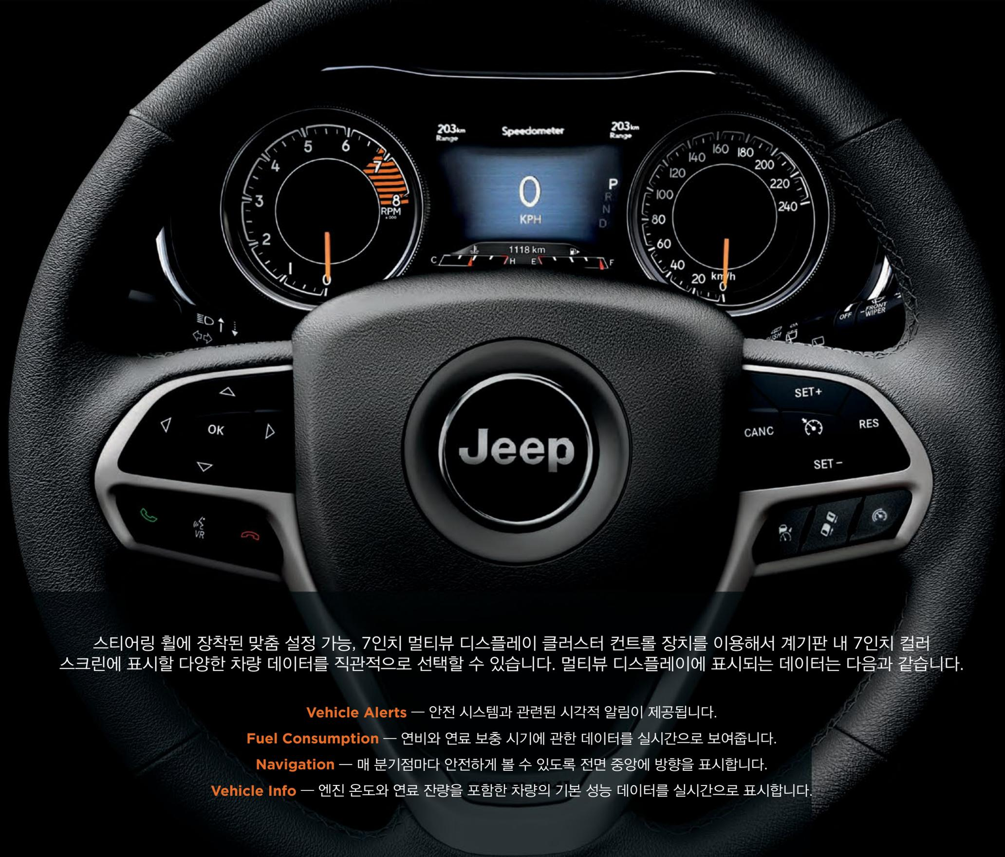
스티어링 휠에 장착된 맞춤 설정 가능, 7인치 멀티뷰 디스플레이 클러스터 컨트롤 장치를 이용해서 계기판 내 7인치 컬러 스크린에 표시할 다양한 차량 데이터를 직관적으로 선택할 수 있습니다. 멀티뷰 디스플레이에 표시되는 데이터는 다음과 같습니다.
