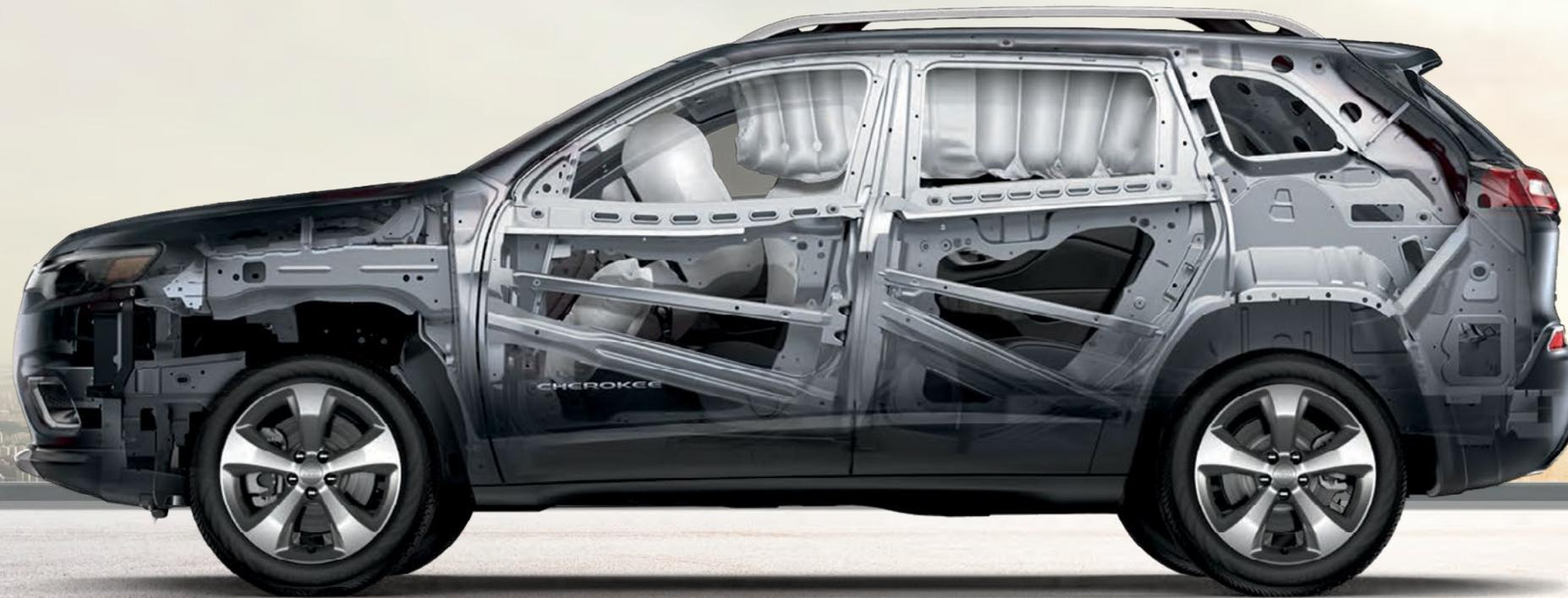
**스탠다드 에어백(STANDARD AIR BAGS)** 풀사이즈 측면 커튼, 운전자, 흉부 보호 사이드 에어백<sup>12</sup> 및 첨단 다단계 전방 에어백<sup>12</sup>이 장착되어 있어 승객 모두의 안전을 책임집니다.
