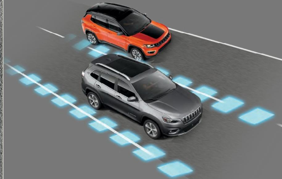
**사각 지대 / 후방 교행 모니터링 시스템** 이 시스템들은 내 차량과 다른 차량 간의 거리를 모니터링하여, 차량이 측면이나 후방의 사각지대 안으로 들어가 위험이 감지되면 사이드 미러의 아이콘에 불이 켜지거나 경보음이 울립니다.
